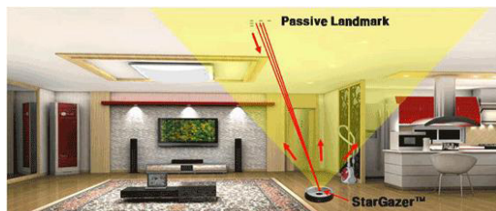
그림 2. [9]의 Stargazer. Passive 랜드마크의 위치를 미리 정해 주어야만 그에 대한 상대 위치로 로봇의 위치 계산이 가능하다.
