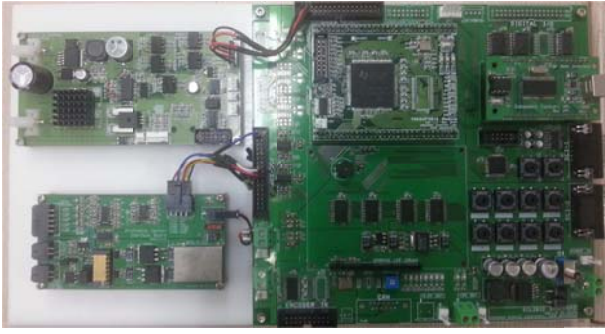
그림 4. 통합 제어 보드. Fig. 4. Integrated control board.
