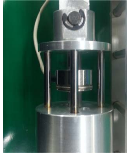
그림 5. 로드셀 설치 모습. Fig. 5. Picture of the installed load cell.
